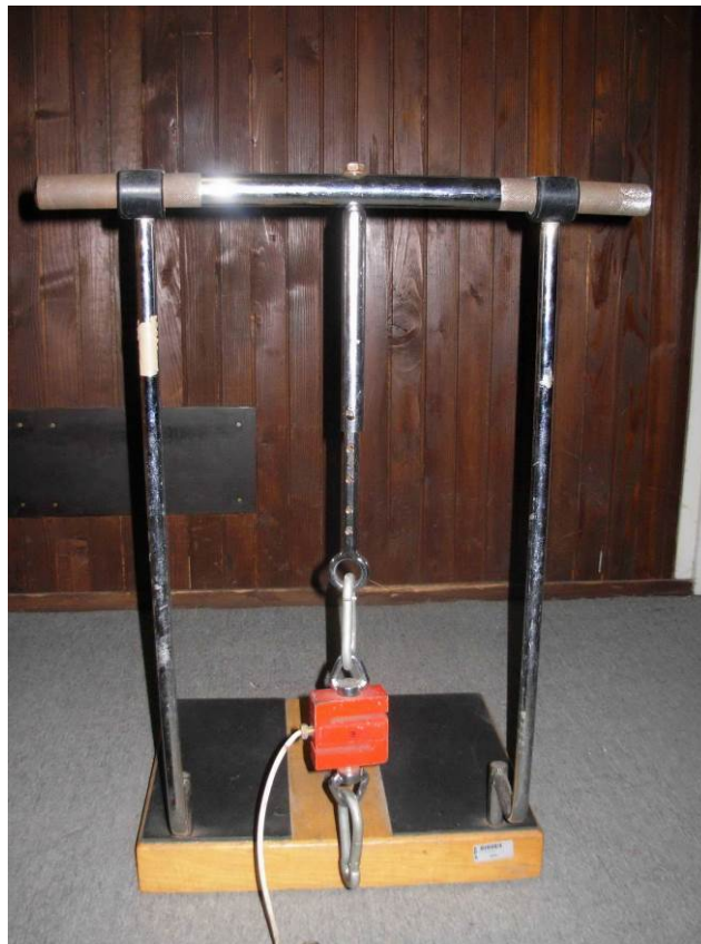
Слика 2. Платформа са тензиометријском сондом за мерење максималне изометријске силе мишића опружача леђа и мишића опружача ногу
