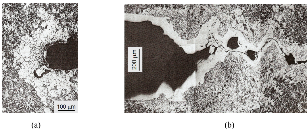
Slika 6.1 Mikrofotografija zatupljene prsline (a) i rasta prsline mehanizmom žilavog loma (b) na CT epruveti izrađenoj od čelika A508 [1.3]
