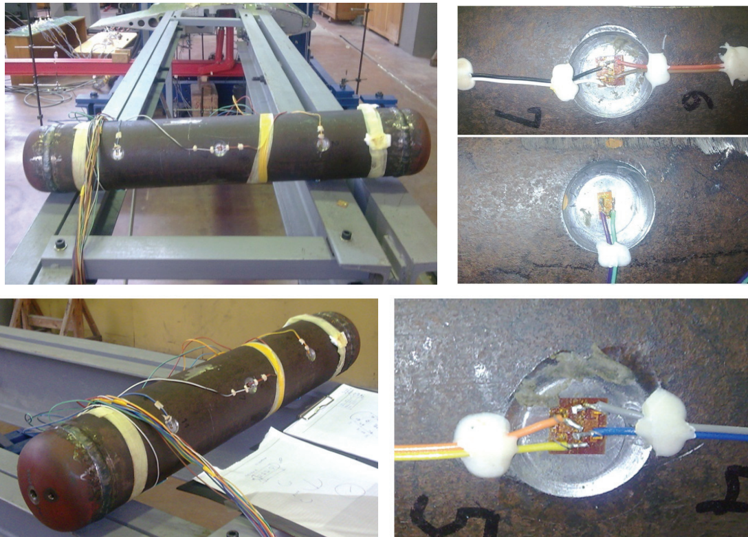
Slika 8.6. Cev pripremljena za ispitivanje pritiskom i simulirana oštećenja sa mernim trakama
