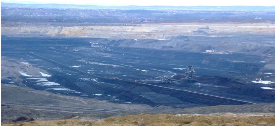
Sl. 4. Pogled na površinski kop i eksploataciju uglja. Uklanjanje prekrivajućih naslaga zemlje i sedimenata (Cvetković i dr., 2012)
