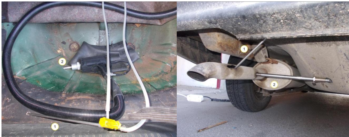
Slika 5-3. Pitova cev i sonda (pogled iz i van vozila)
