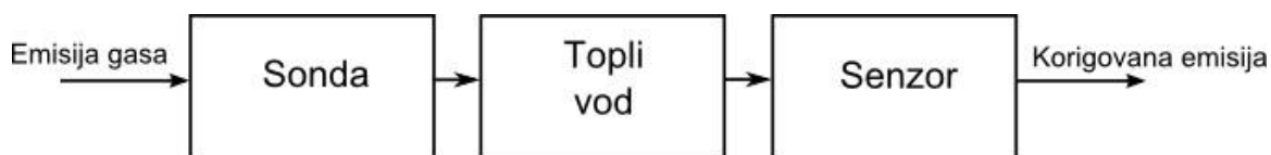
Slika 5-8. Blok dijagram uređaja za merenje emisije
