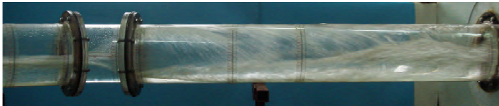
Слика 5ц. Хеликоидно течење код кога се млаз потпуно окренуо, али не долази до загушења тока
