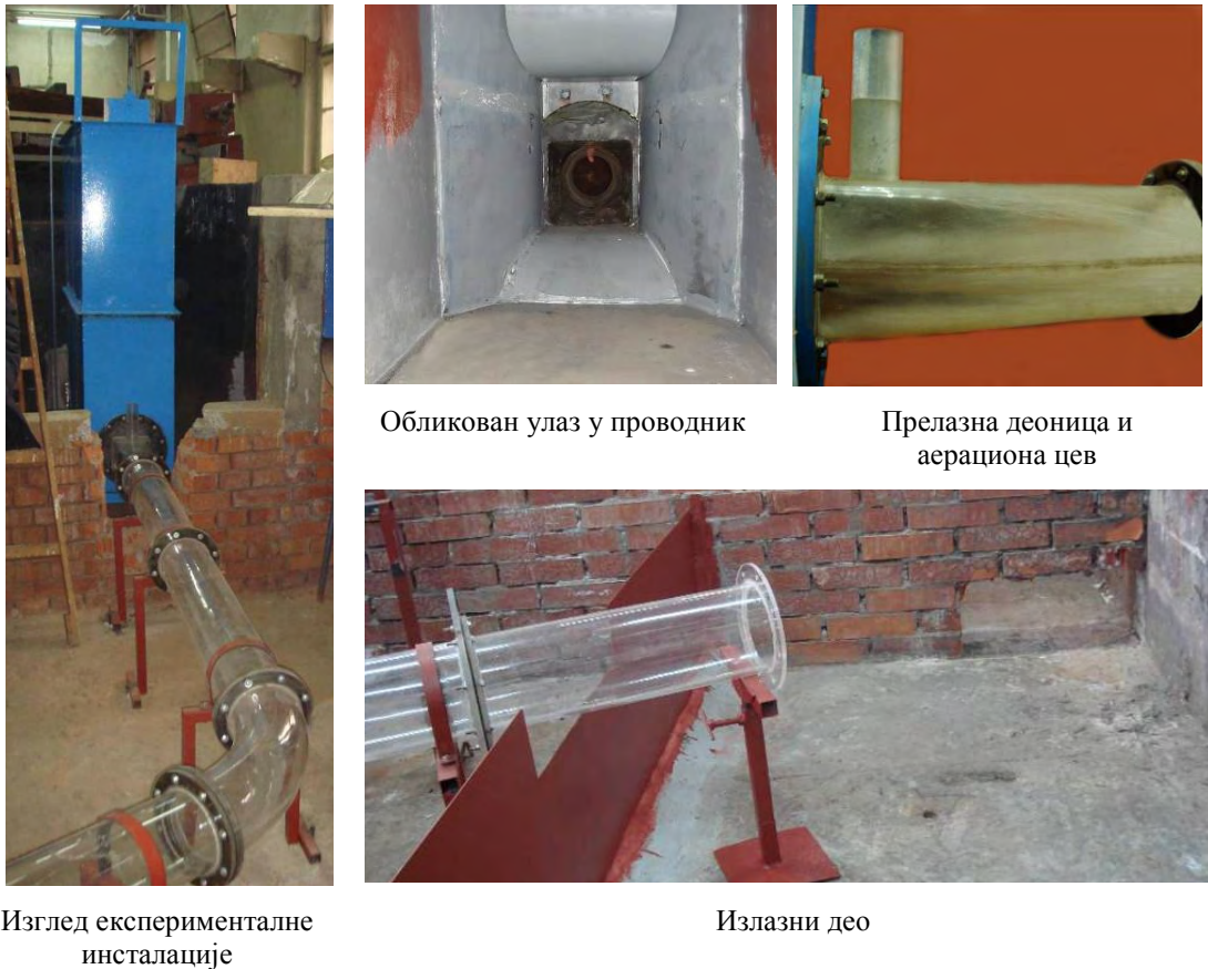
Слика 4. Фотографије експерименталне инсталације
