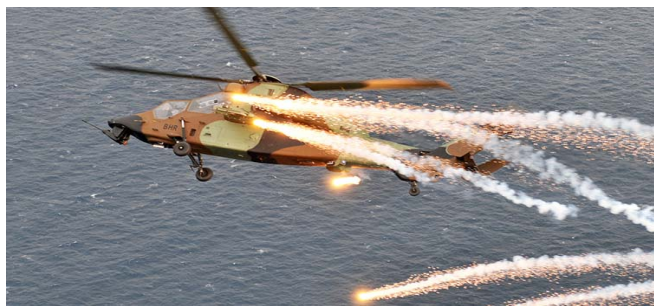
Слика 7: Испуштање ИЦ Мамаца из контејнера монтираних на хеликоптеру Еурокоптер Тигар (lacroix-defence.com)
