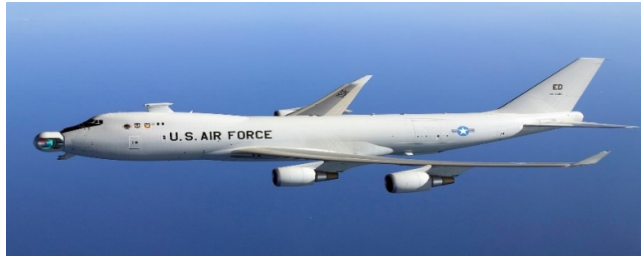
Слика 25: Boeing YAL-1 авион прототип у лету са монтираном ласерком куполом на носу (US Missile Defence Agency)
