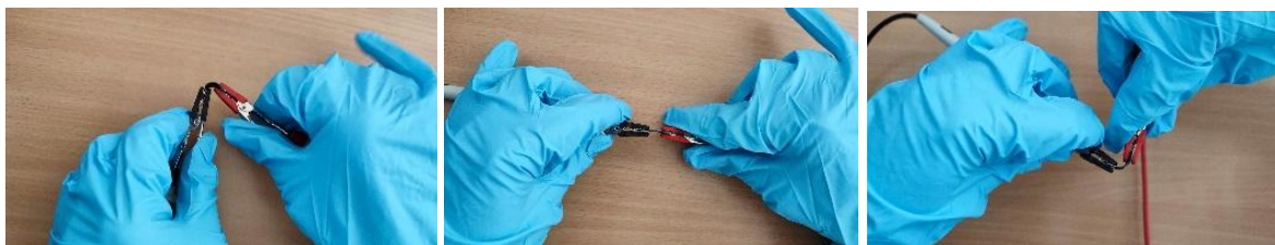
Slika 52 - PU-maksen senzor u različitim pozicijama naprežanja. Prema 148
