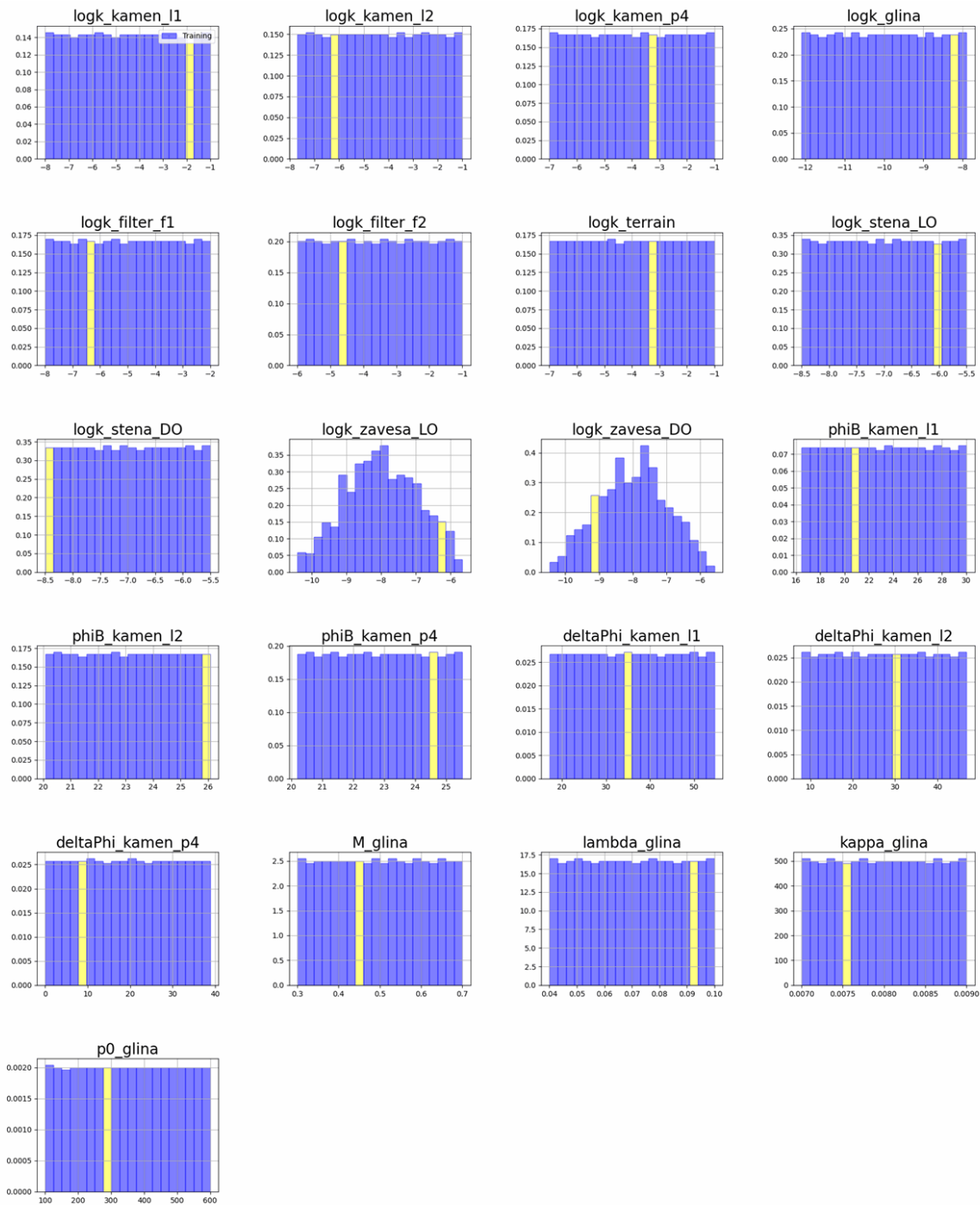
Слика 6.31 Хистограмске расподеле LHS узорка за свих 21 улазних променљивих. Жутим бојом су обележени бинови из којих су узорковани параметри за једну случајно одабрану симулацију. 6
