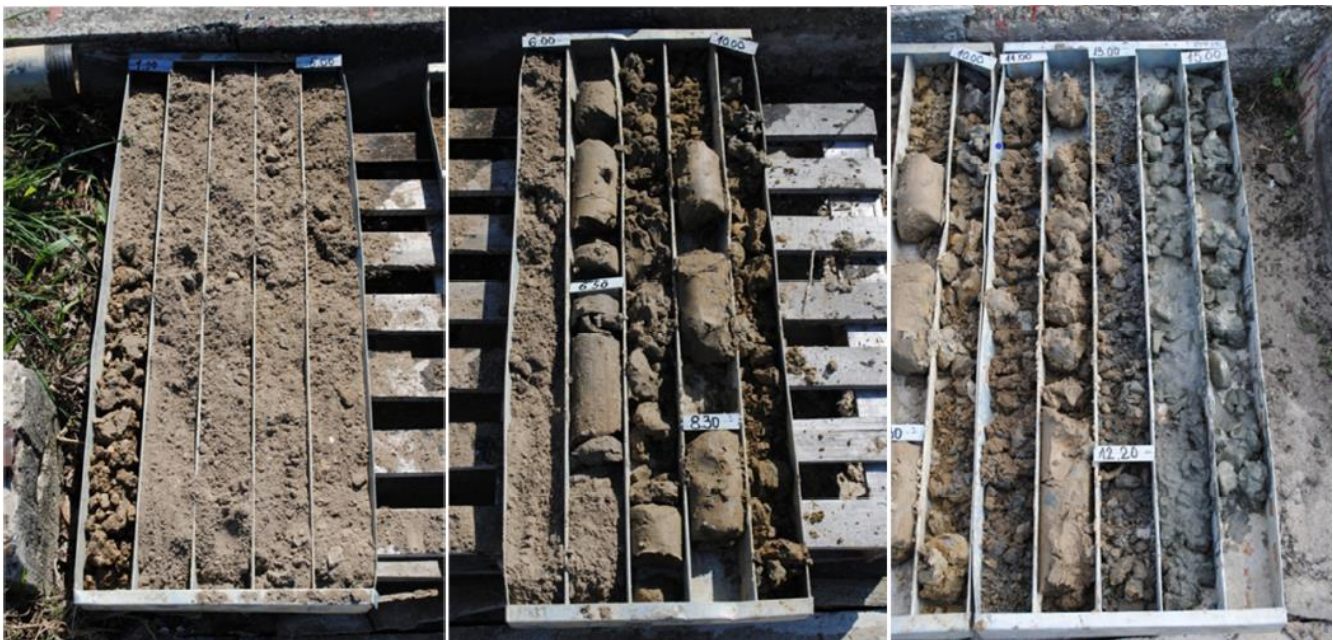
Slika 3.1. Jezgro nabušeno na jednoj od lokacija sa vidljivim litološkim članovima pre uzimanja kompozitnih uzoraka
