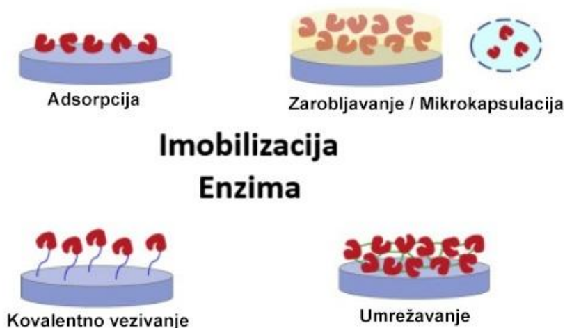
Slika 2.7. Metode imobilizacije enzima [131]
