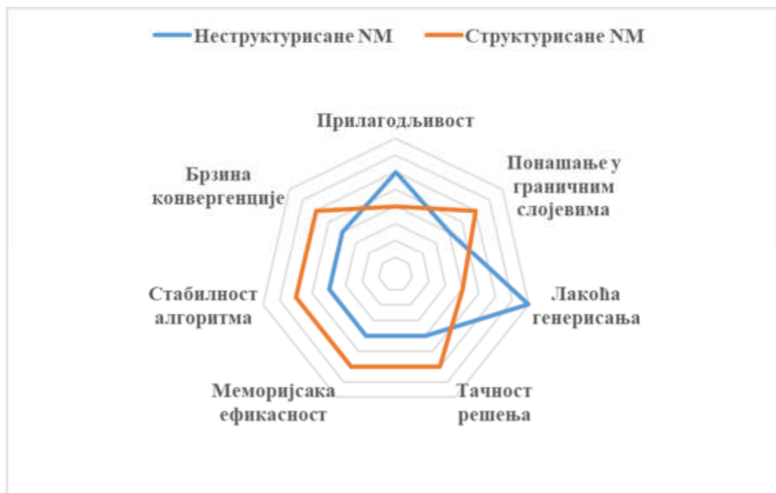
Слика 5-12: Упоредна анализа применљивости структуралне и неструктуралне мреже.
