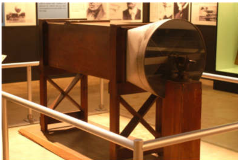
Слика 2-8 Аеротунел браће Рајт (Wright) из 1901. године [15].
