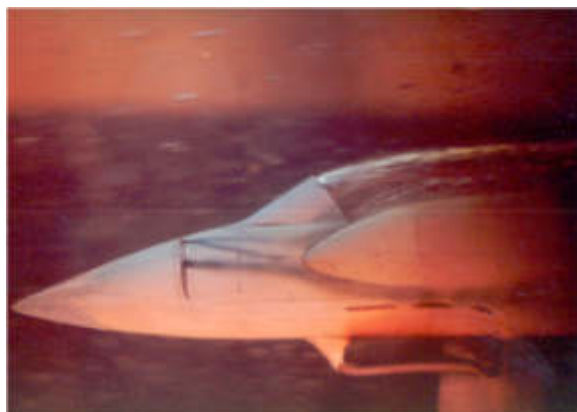
Слика 3-23: Визуелизација бојом у воденом тунелу ВТИ [107].
