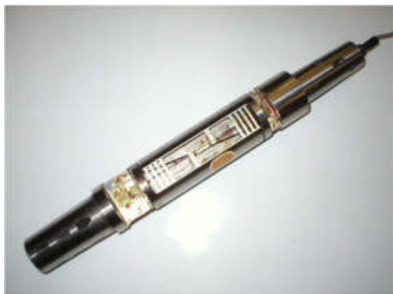
Слика 3-9: ВТИ-јев шестокомпонентни ИМО напона [106].
