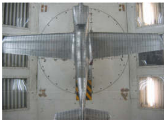
Слика 3-21: Визуелизација струјања у граничном слоју употребом памучних кончића, модел авиона Ласта при V=100\text{m/s} [107].
