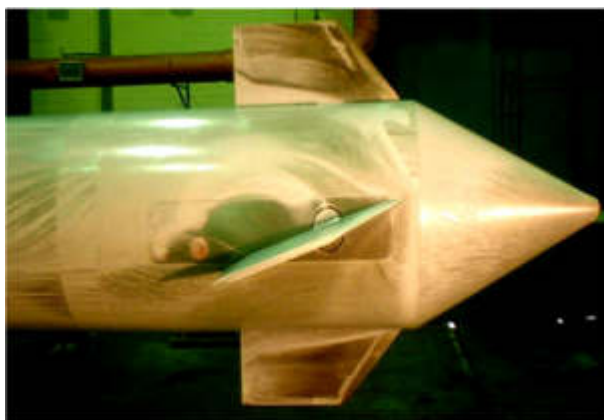
Слика 3-19: Визуелизација струјања граничног слоја уљним филмом при M=0,9 [107].
