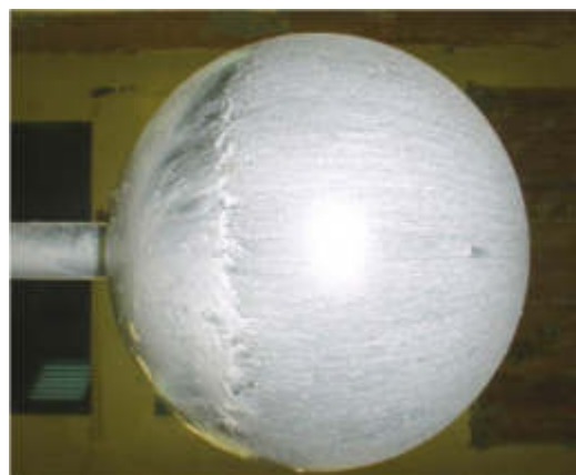
Слика 3-20: Визуелизација струјања граничног слоја уљним филмом при M=0,2 [107]
