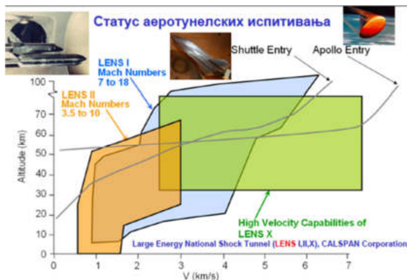
Слика 2-13 Могућност експерименталне базе CUBRC у односу на путање Аполо и Шатла при повратку [1], [2].
