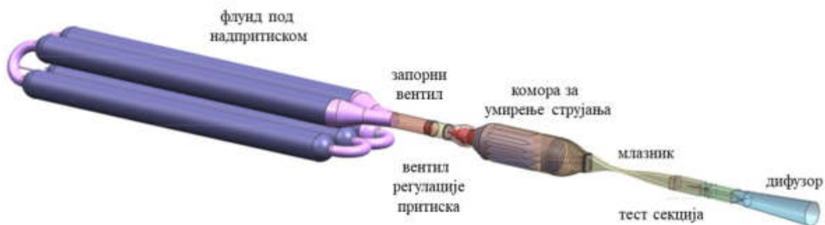
Слика 3-14: Функционална шема рада аеротунела Т-38, ВТИ [3], [116].
