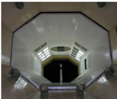
Слика 3-7: Т-35 изглед радног дела са стубном аеровагом и изгледом ињекторских млазница [106].
