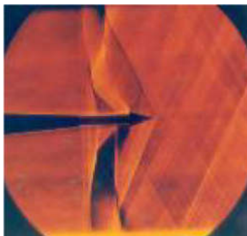
Слика 3-26: Визуелизација шпиреном конуса при M=1,02 [108].
