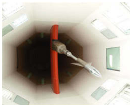
Слика 3-8: Т-35 модел AGARD-B у положају испитивања [106]
