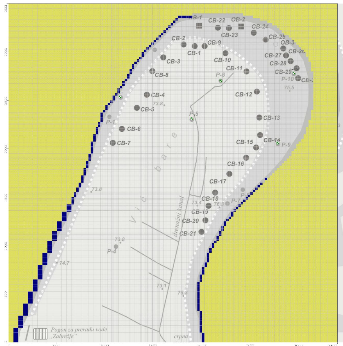
Slika 3.42. Prikaz graničnog uslova „reka“ (plava polja) u prvom sloju hidrodinamičkog modela izvorišta „Vić bare“ (Polomčić et al. 2013)
