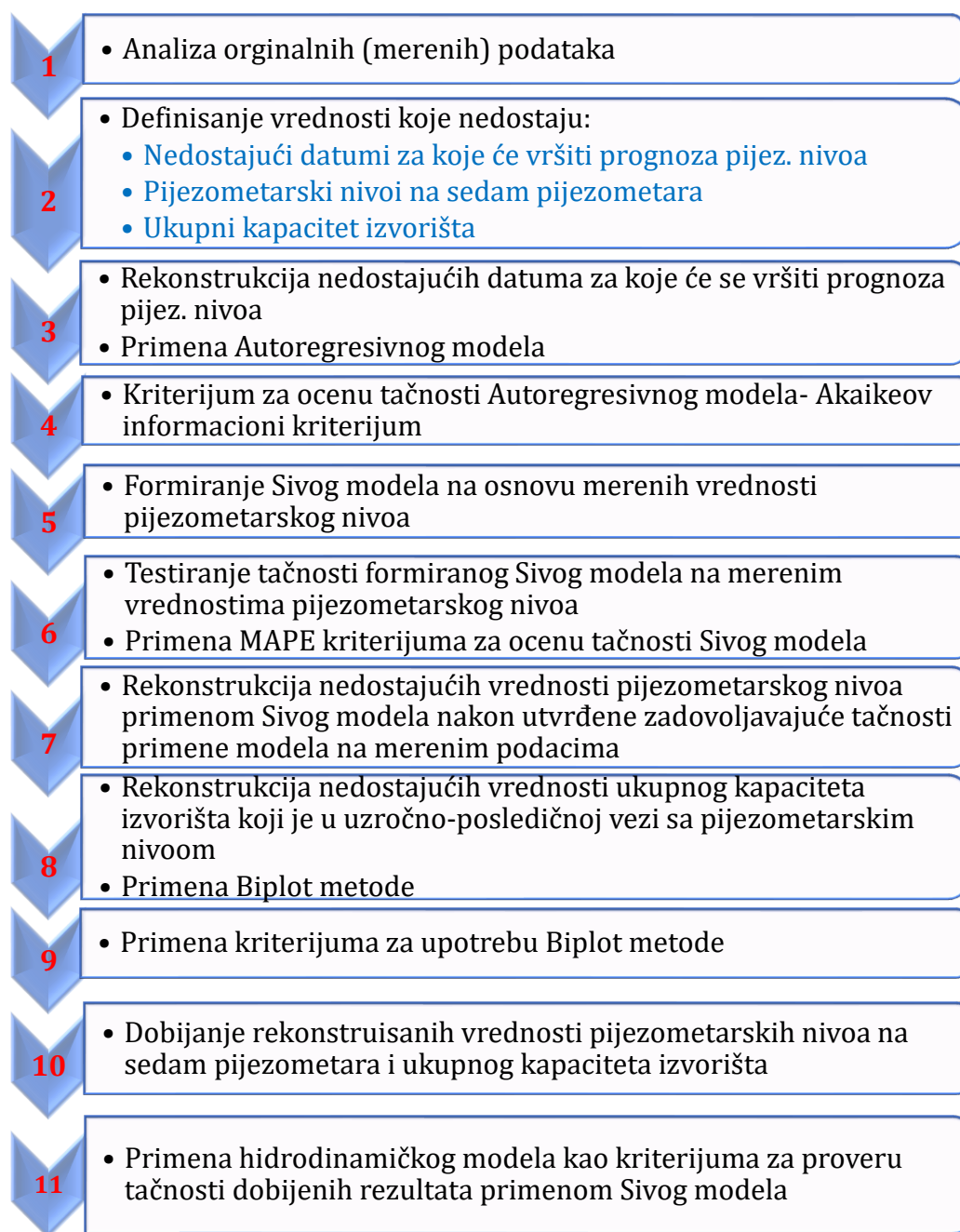
Slika 4.3. Algoritam metodologije za rekonstrukciju nedostajućih podataka na numeričkom primeru izvorišta “Vodokanal” primenom Sivog modela
