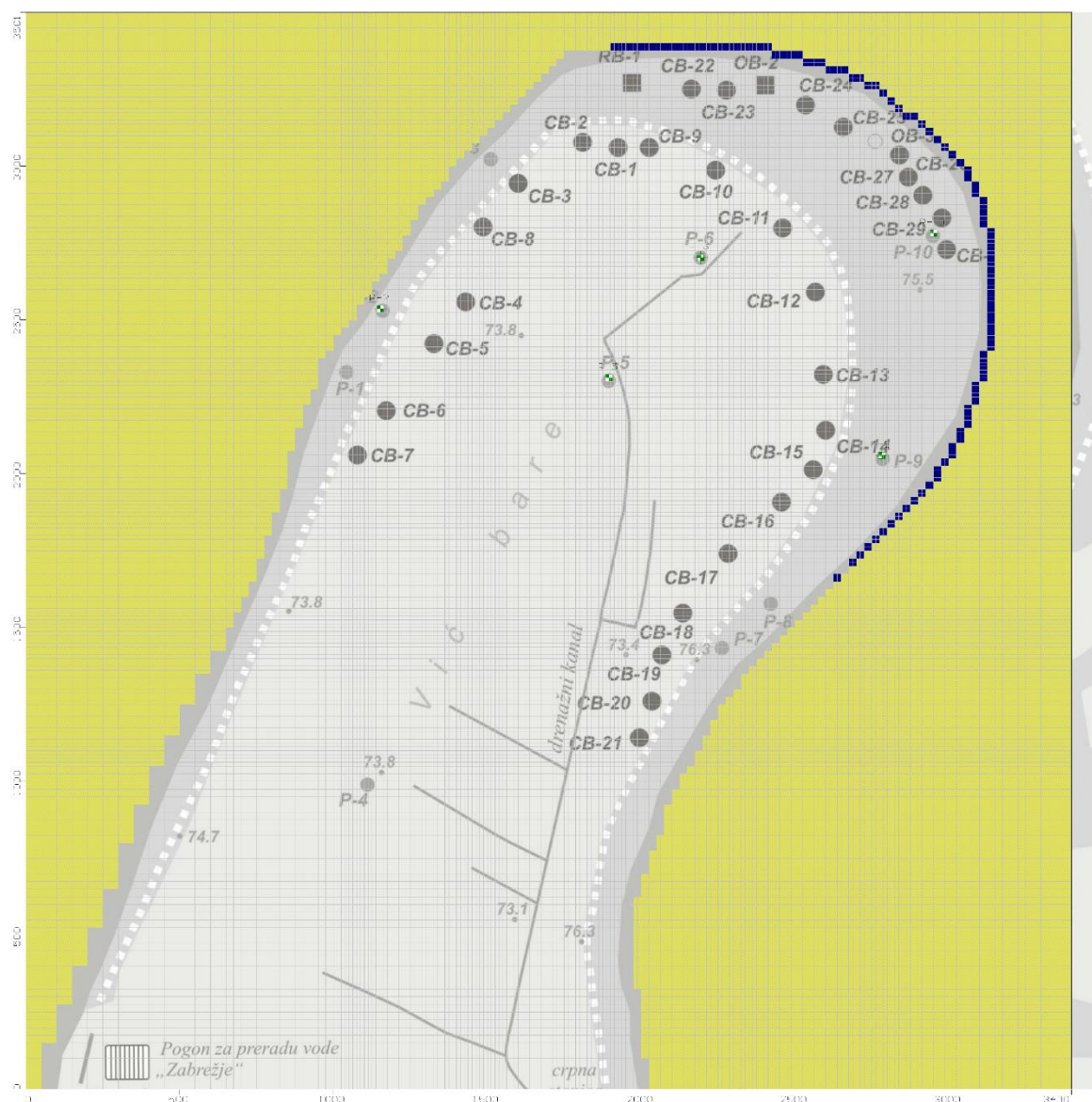
Slika 3.43. Prikaz graničnog uslova “reka” (plava polja) u drugom sloju hidrodinamičkog modela izvorišta “Vić bare” (Polomčić et al. 2013)
