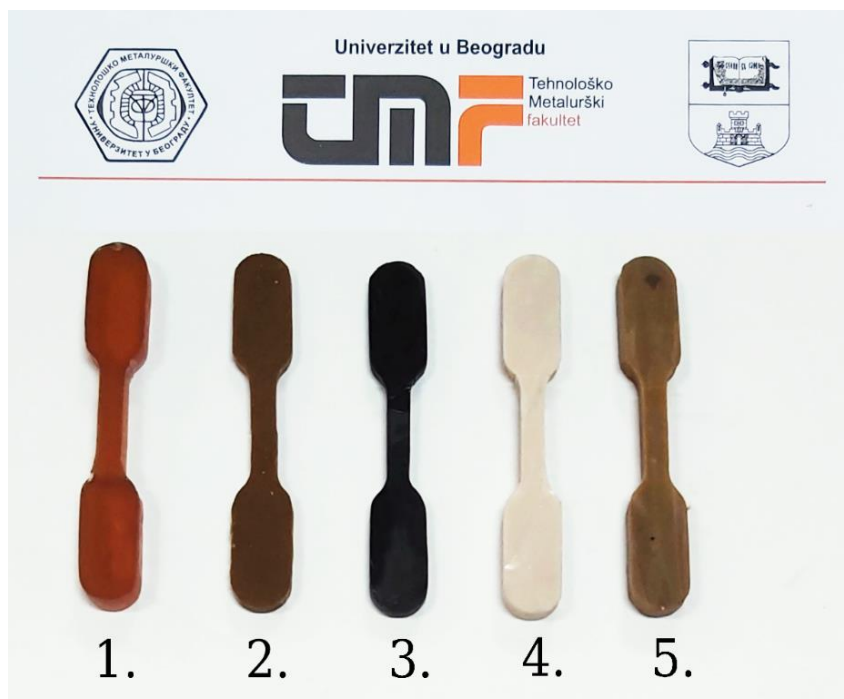
Slika 42. Standardni test kalupi za jednoosna zatezna merenja: 1. NPSM; 2. NPSM/OF 15 mas.% ; 3. NPSM/A-KL 15 mas.% ; 4. NPSM/A-KL 5 mas.% /OF 10 mas.% ; 5. NPSM/A-KL 10 mas.% /OF 5 mas.%
