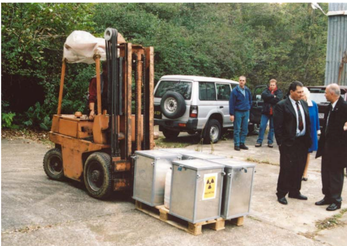
Слика 9. Процес складиштења радиоактивног отпада у привременом складишту за чврсти радиоактивни отпад ниског нивоа Нуклеарног института Винча (UNEP, 2002)
