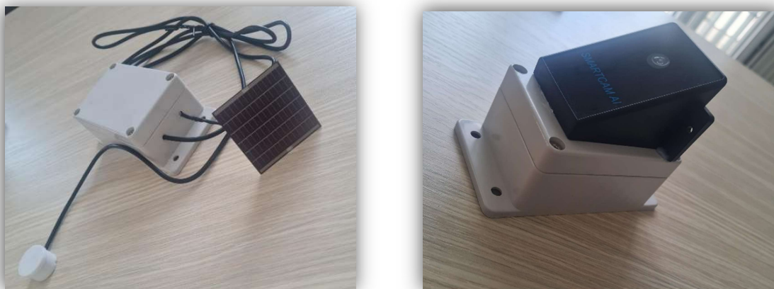
Slika 51. Rešenja - Uređaj za detekciju nivoa popunjenosti u buretu (levo), IoT kamera (desno)
