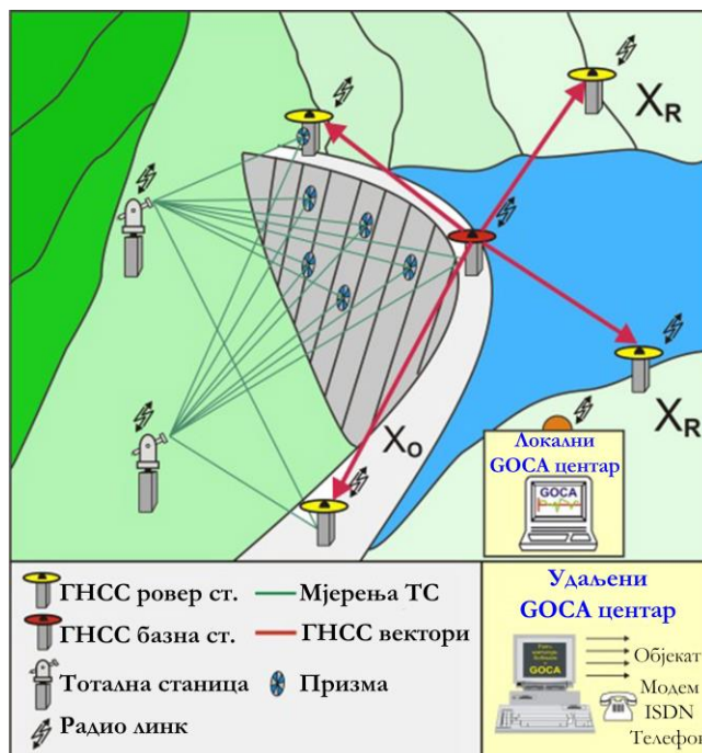
Слика 3-4. Принципи рада и компоненте GOCA система [238]
