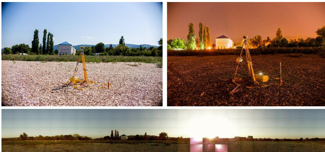
Слика 6-16. Кориснички успостављен базни пријемник са панорамским приказом локације
