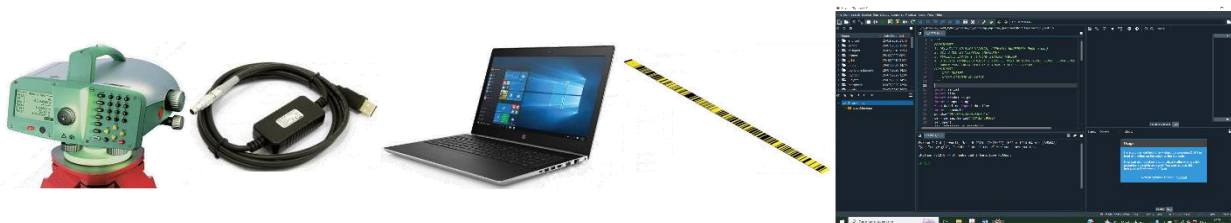
Слика 6-3. Дигитални прецизни нивелир Leica DNA03 са припадајућом инварском летвом и системом за аутоматско управљање
