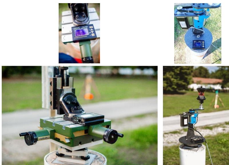
Слика 6-9. Хоризонтисање симулатора помјерања
