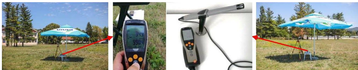
Слика 6-13. Мјерење атмосферских параметара за корекцију мјерења
