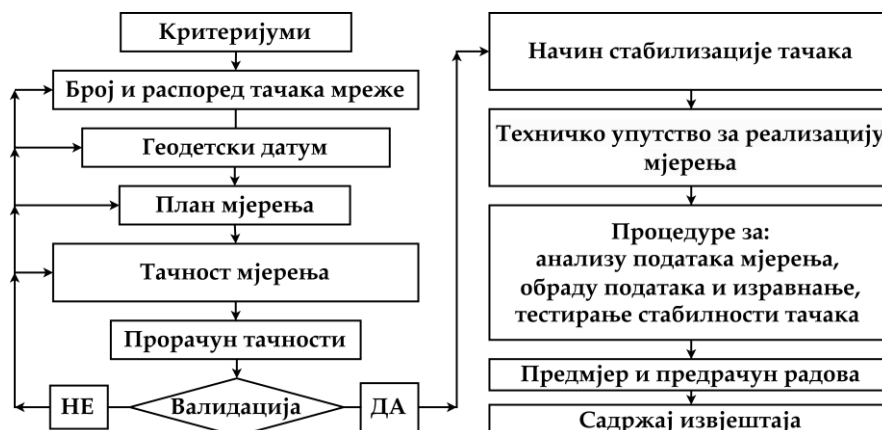
Слика 3-1. Алгоритам пројектовања геодетске контролне мреже [208], [209]
