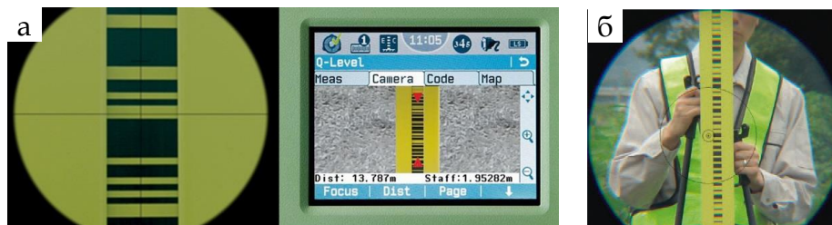
Слика 2-7. Технологија аутоматског фокусирања: Leica (а), Sokkia (б)
