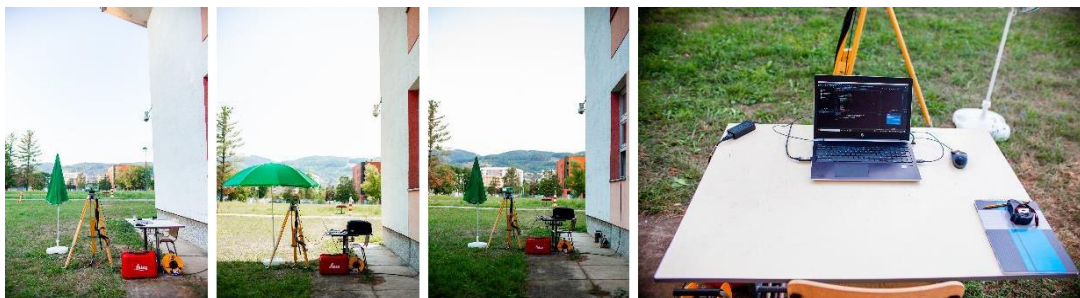
Слика 6-14. Постављање и заштита дигиталног прецизног нивелира у току регистравања помјерања
