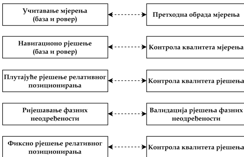
Слика 5-1. Дијаграм тока основних и опционих корака релативног/RTK позиционирања
