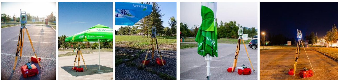
Слика 6-12. Постављање и заштита роботизоване тоталне станице у току регистравања помјерања
