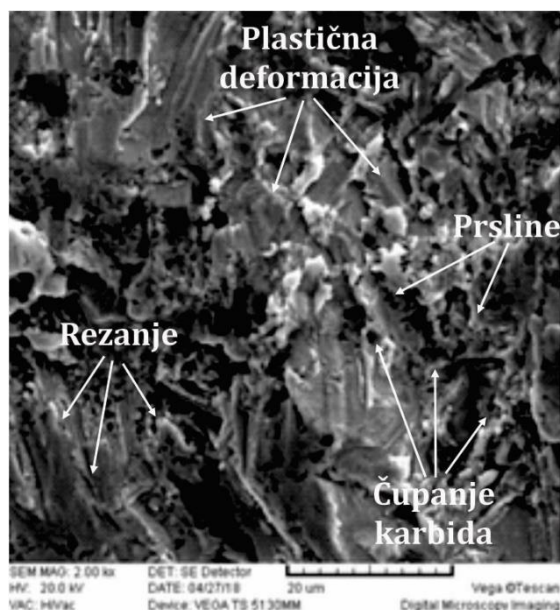
Slika 4.27. SEM mikrografija erodirane površine uzorka HCCI-PTA
