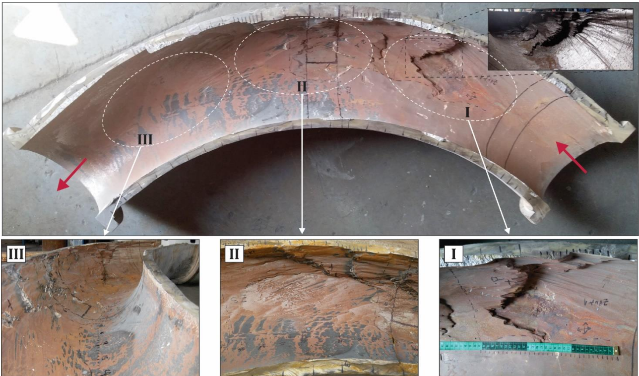
Slika 4.29. Cevni luk ( in-situ ): izgled unutrašnje površine nakon ~16000h rada
