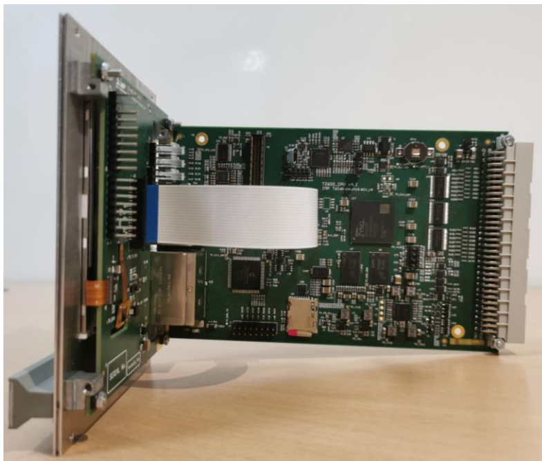
Слика 21 – Реализовани централни процесорски модул телезаштитног терминала TZ-600
