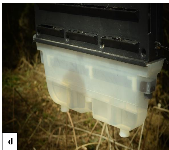
Slika 14. Feromonske klopke: a- suva; b- mokra; c- so za konzervaciju; d- posuda sa vodom (kolektor) mokre klopke
