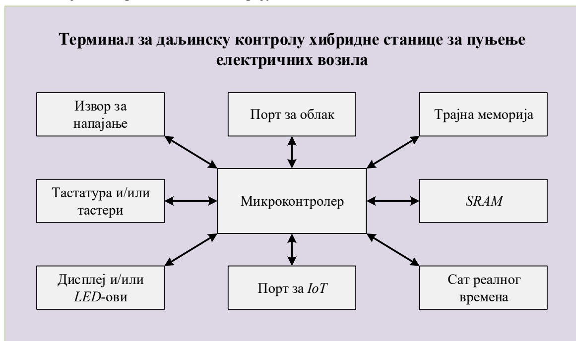
Слика 7-2 Блок шема хардвера терминала [31]
