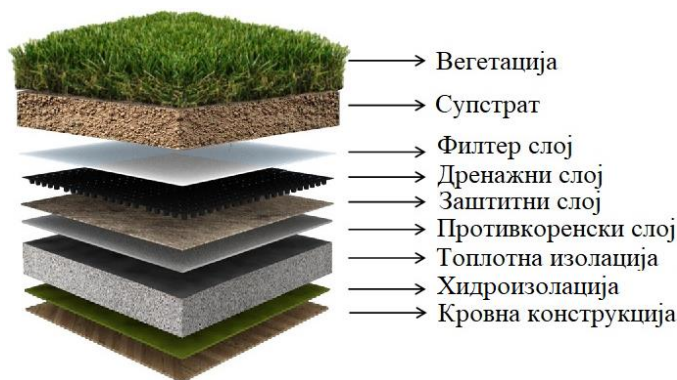
Слика 2.1. Компоненте типичног зеленог кровног система [16]
