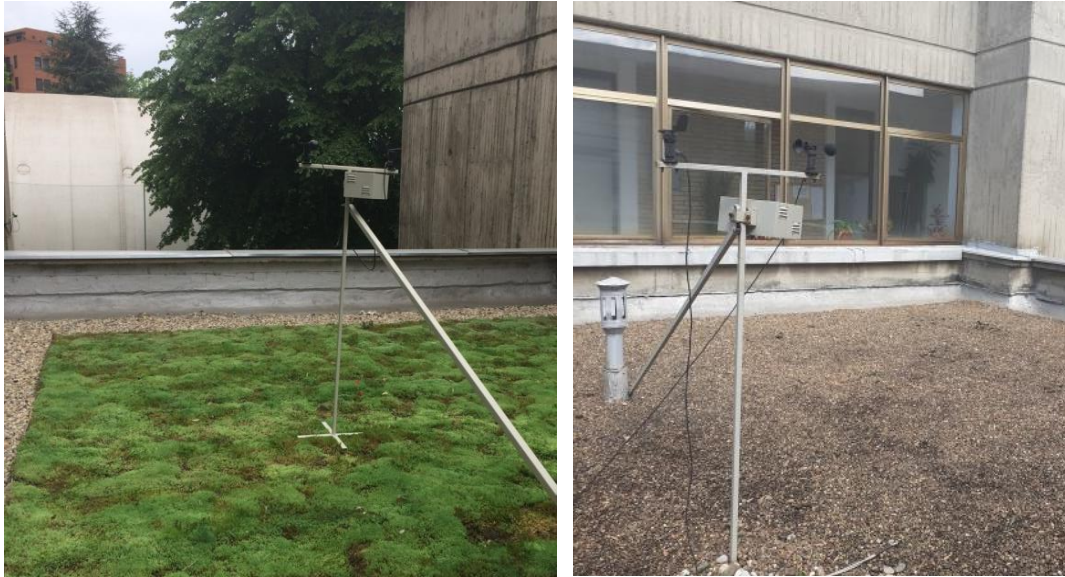
Слика 6.5. а) Зелени кров са мерним инструментима и сензорима, б) конвенционални кров са мерним инструментима и сензорима
