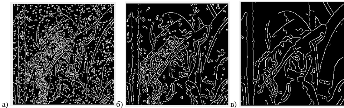
Слика 2.19 - Детекција ивица применом Canny алгоритма у присуству веће количине шума у слици: а) \sigma = 0.7 , б) \sigma = 1.4 , в) \sigma = 2.1 .
