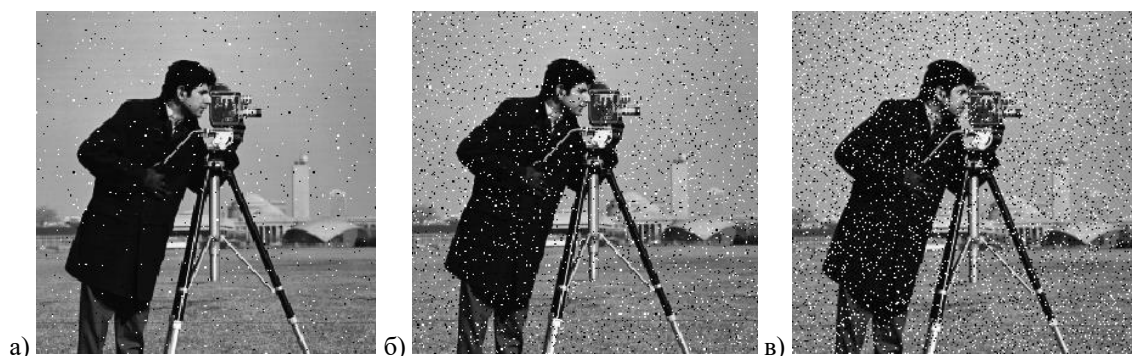
Слика 7.5 - Пример слике са различитим интензитетом Salt and Pepper шума: а) 0.01, б) 0.05, в) 0.1.
