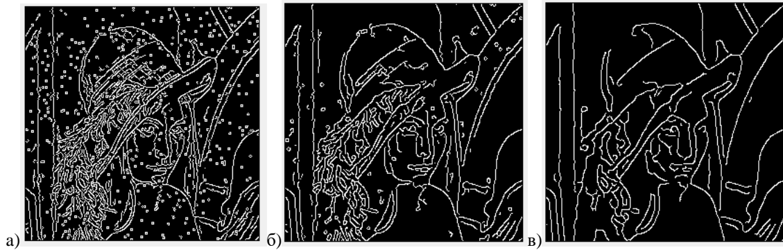
Слика 2.18 - Детекција ивица применом Canny алгоритма у присуству мање количине шума у слици: а) \sigma = 0.7 , б) \sigma = 1.4 , в) \sigma = 2.1 .
