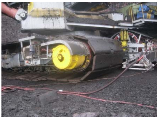
сл. 9.1 Погонска група мотор-редуктор на једној гусеници багера SRs 400
