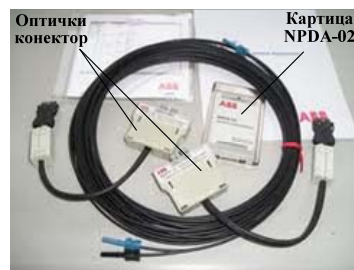
сл. 9.7 NPDA-02 картица и оптички адаптер
