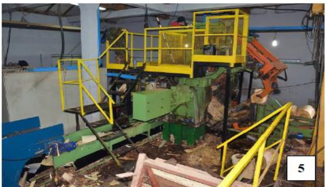
Фототаблица 1: 1. допрема трупца покретном траком; 2-4. скидање коре са трупца; 5. љуштилица за фурнир; 6. фурнир настао у процесу љуштења.
