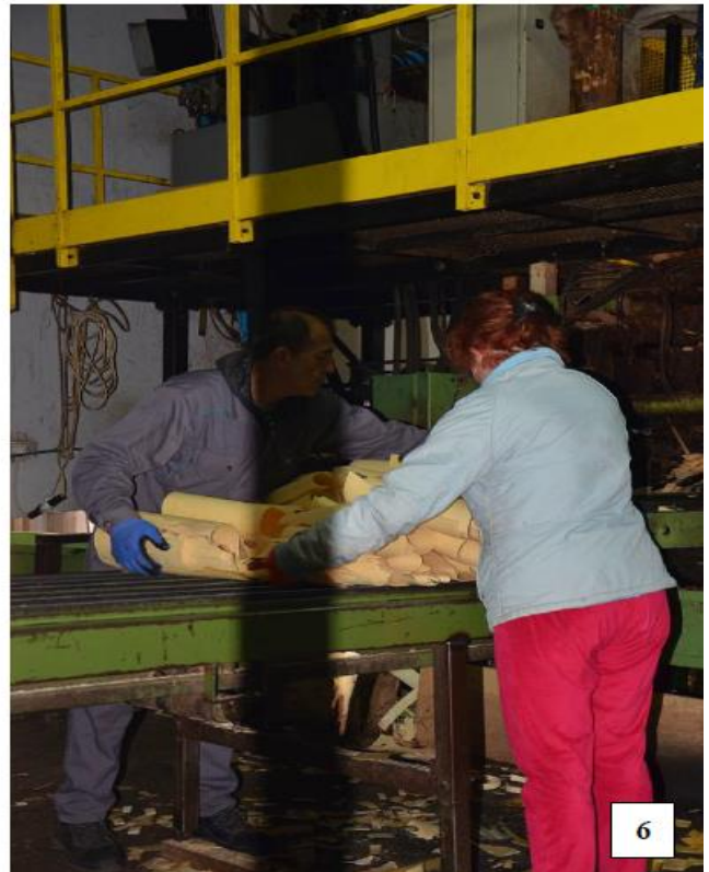
Фототаблица 1: 1. допрема трупца покретном траком; 2-4. скидање коре са трупца; 5. љуштилица за фурнир; 6. фурнир настао у процесу љуштења.
