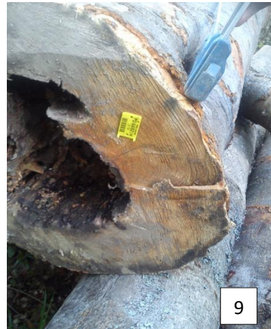
Фототаблица 3: 1. подсецање стабла; 2. обарање стабла; 3. обрада чела трупца; 4. кројење дрвних сортимената; 5. прорезивање дебла; 6. качење трупца; 7. утовар дрвних сортимената; 8. мобилни уређај за пријем, привлачење и отпрему дрвних сортимената; 9. плочица са баркодом за отпрему дрвних сортимената.
