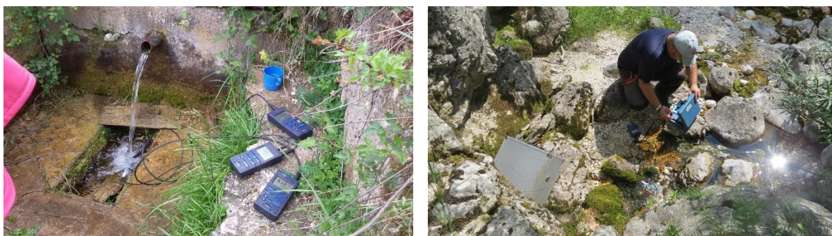
Sl. 9.6. Terenski uređaji za in situ merenja hemijskih parametara podzemnih voda (levo); in situ određivanje parametara kvaliteta karstnih podzemnih voda na terenu (desno)
