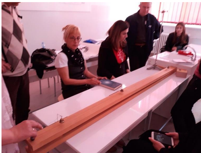
Слика 1. Реплика оригиналне стрме равни са звончићима из Галилејевог времена. (Земунска гимназија)
