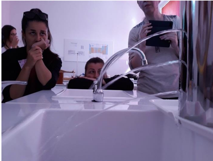
Слика 4. Пресек три млаза из Торичелијеве фонтане (Кладово, мај 2019).
