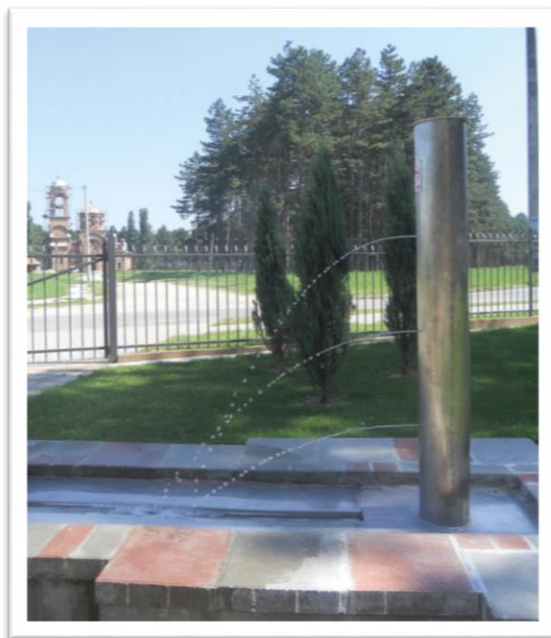
Слика 20. На Торичелијевој фонтани, у Центру за стручно усавршавање наставника у Шапцу, Србија [48], јасно се виде три параболична млаза које је описао Торичели.
