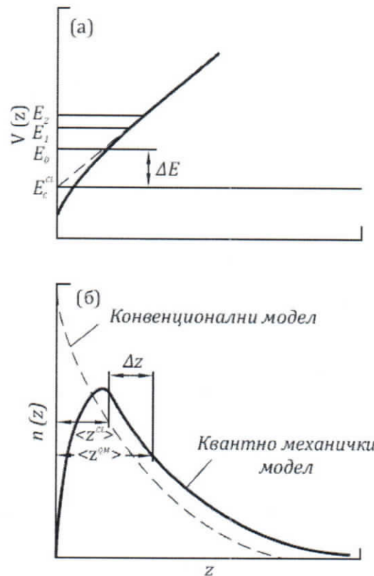
Сл. 6.1. Шематски приказ класичне и квантно механичке расподеле потенцијалне енергије у јакој инверзији (а) и концентрација електрона у функцији растојања (б).
