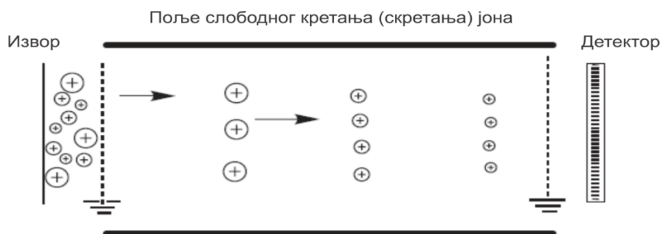
Слика 10: Поједностављена шема TOF масеног анализатора (35)
