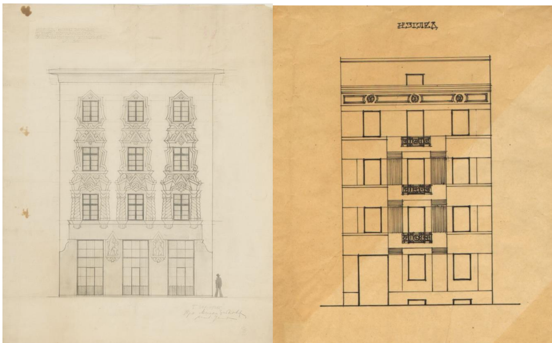
Слика 4. Зграда Ђуре Богданића, Студеничка 45; неизведено решење фасаде (лево, МГБ, ЛМЗ_223) и изведено (десно, ФМЗ)
