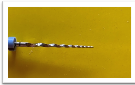
Slika 5.64. Nativni snimak instrumenta F2 treće grupe, (ne uočava se fraktura)
