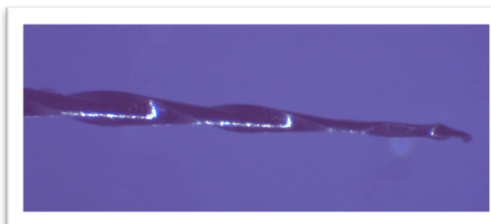
Slika 5.33. Stereomikrofotografija apikalnog segmenta MTwo instrumenta 15/0.05 treće eksperimentalne grupe sa promenjenim navojima
