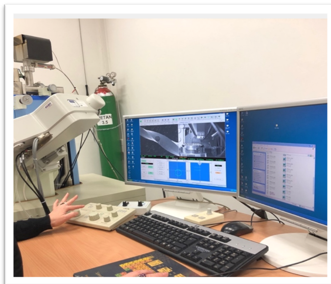
Slika 4.11. SEM-EDS analiza, realizovana u Laboratoriji za SEM Rudarsko-geološkog fakulteta Univerziteta u Beogradu; na monitoru se vidi instrument tipa MTwo
