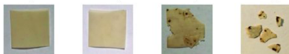
Slika 17. Biorazgradnja PHB polimera u kompostu (po standardu ISO 20200); Prikazan je PHB polimer nakon (sleva na desno): 7 dana, 19 dana, 28 dana i 33 dana. Slika je preuzeta iz rada Sančez-Safont i saradnika (Sánchez-Safont, Aldureid et al. 2020)
