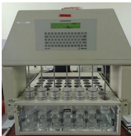
Slika 3.2. Aparatura sa cilindrom sa povratnim kretanjem (Bio-Dis Extended Release Tester, VanKel Technology Group, SAD)
