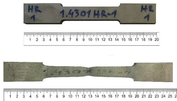
Slika 3.5 – Epruveta od nerđajućeg čelika pre i nakon ispitivanja
