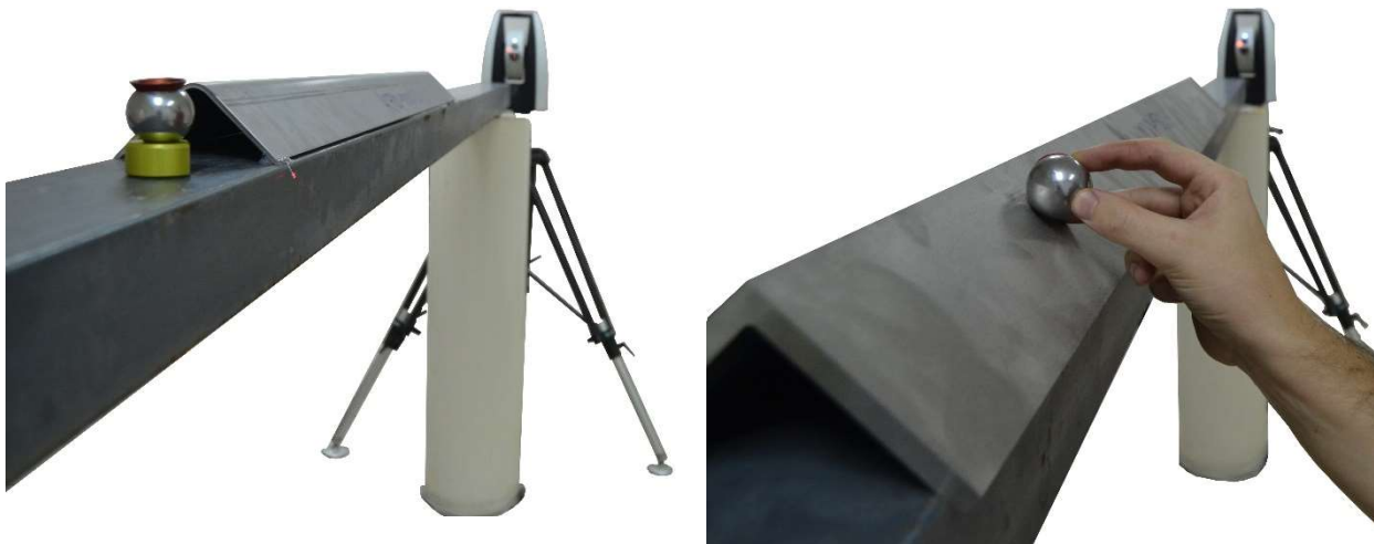
Slika 3.13 – Ilustracija merenja mernim sistemom Leica Absolute Tracker AT960
