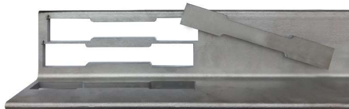
Slika 3.3 – Epruveta iz gotovog proizvoda vrućevaljanog ugaonika
