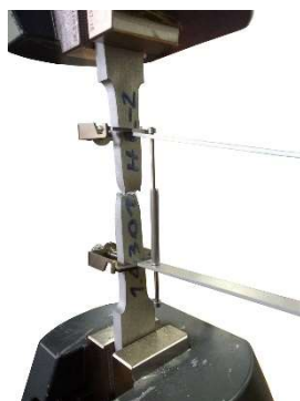
Slika 3.4 – Ispitivanje epruvete testom na zatezanje
