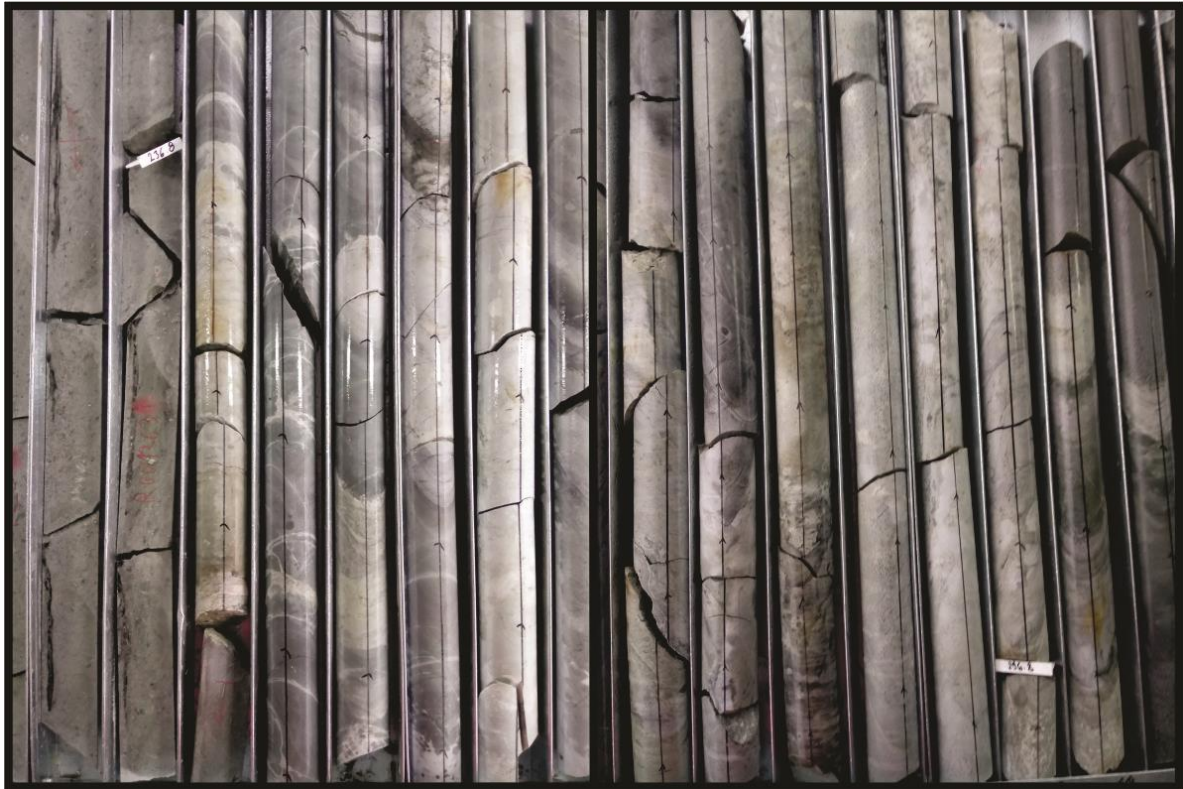
Slika 11: Izgled jezgara bušotina nabušenih metaalevrolita sa očuvanom laminacijom.
