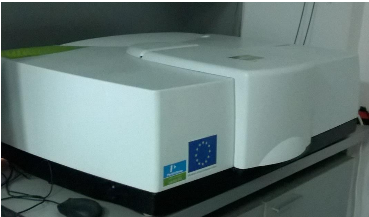
Slika 14. Infracrveni spektrometar Lambda 950
