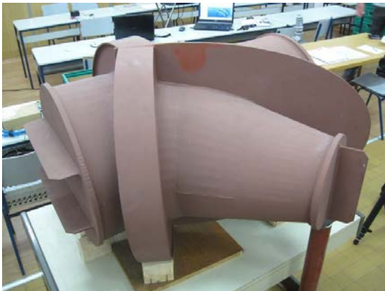
Slika 7.4. Umanjeni model račve A6 cjevovoda [47]
