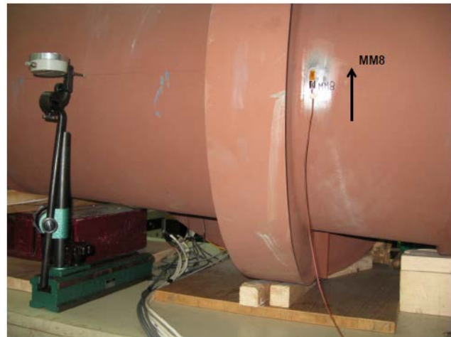
Slika 7.25. Mjerna mjesta MM8, na kojima su postavljene mjerne trake za mjerenje deformacije [47]
