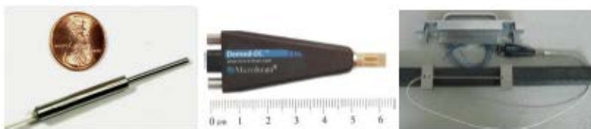
Slika 5.12. Oprema za ekstenziometrijsko mjerenje: senzor pritiska fluida, induktivni senzor napona...
