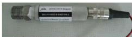
Senzor pritiska fluida, IHTM, Srbija – 60 bar , tačnost 0,6%
