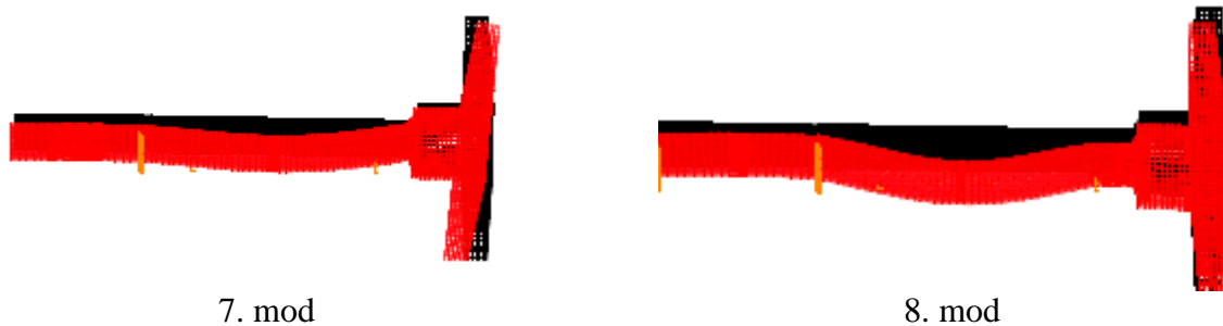
Slika 8.38. Oblici oscilovanja 5,6,7 i 8 vratila u HE "Đerdap 2"
