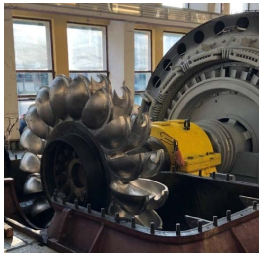
Slika 3.11. Primjer vratila sa radnim kolom hidro - turbine
