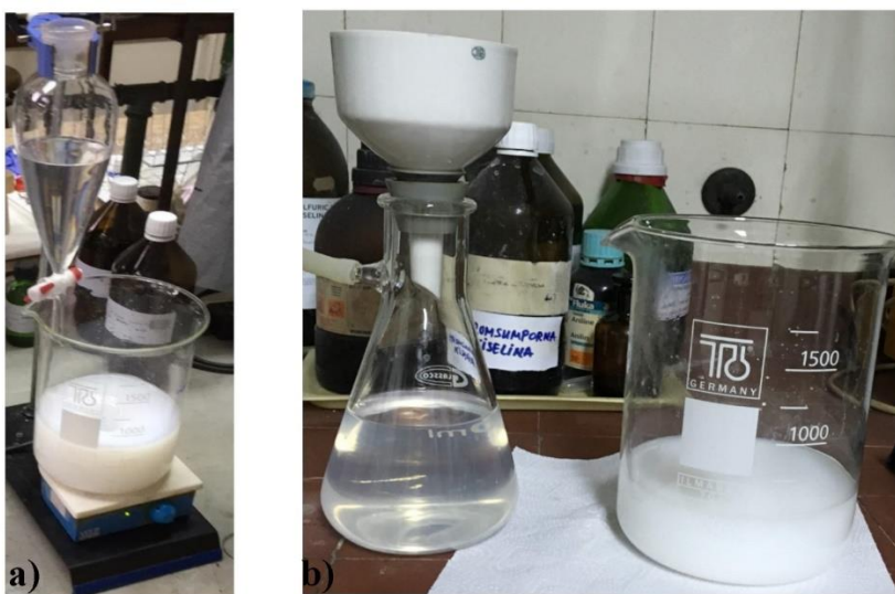
Slika 24. Sinteza MOF-5 : a) Postepeno dodavanje rastvora \text{Zn}(\text{OAc})_2 \cdot 2\text{H}_2\text{O} rastvoru tereftalne kiseline u DMF i stvaranje taloga MOF-5 . b) Filtriranje reakcione smeše.
