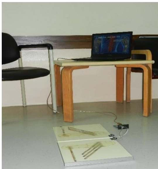
Слика 28: Приказ комплетног мерно-аквизиционог система
