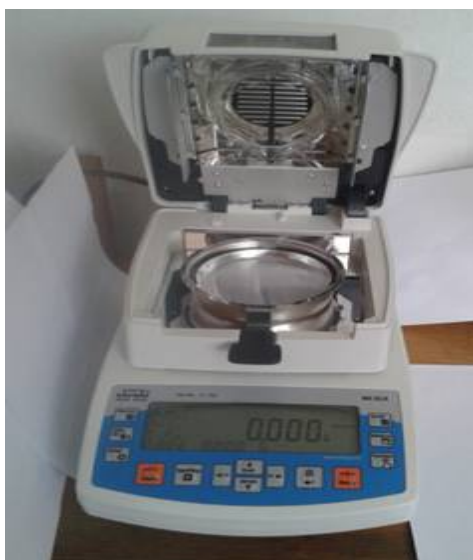
Slika 6.2. Uređaj za merenje sadržaja vlage u materijalu (RADWAG MA 50.R)
