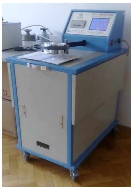
Slika 6.6. Uređaj za merenje propustljivosti vazduha NBFY (model YG461E)
