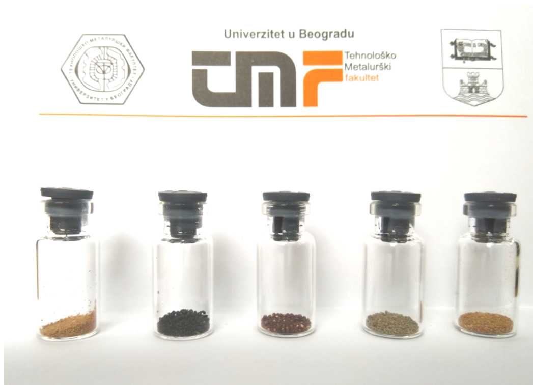
Slika 20. Okarakterisani A-LMS adsorbenti: a) A-LMS_1, b) A-LMS_5, c) A-LMS_10 d) A-LMS_Fe 3 O 4 i e) A-LMS_MnO 2
