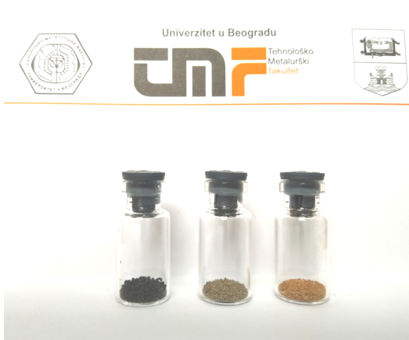
Slika 19. Fotografija sintetisanih a) A-LMS, b) A-LMS_ \text{Fe}_3\text{O}_4 i c) A-LMS_ \text{MnO}_2 adsorbenata
