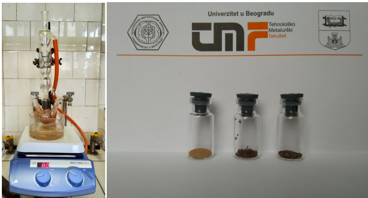
Slika 16. Prikaz aparature za sintezu sa fotografijom sintetisanih a) A-LMS_1 , b) A-LMS_5 i c) A-LMS_10 adsorbenata
