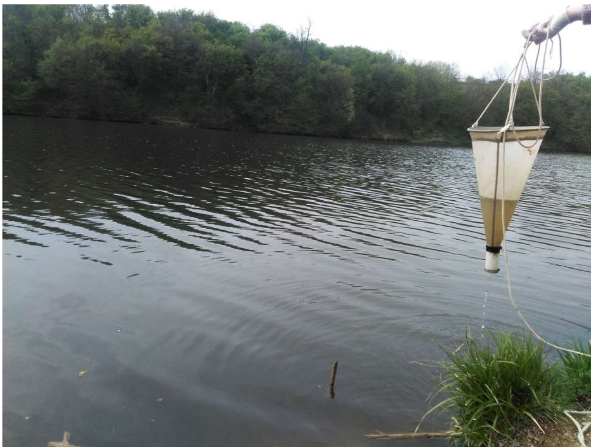
Slika 3.6. Uzimanje uzoraka za kvalitativnu analizu fitoplanktona uz pomoć planktonske mrežice.
