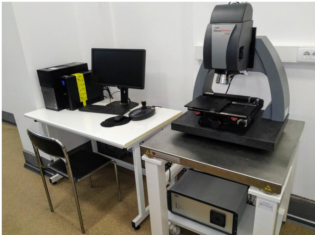
Slika 3.11. Optički profilometar Zygo NewView 7100.
