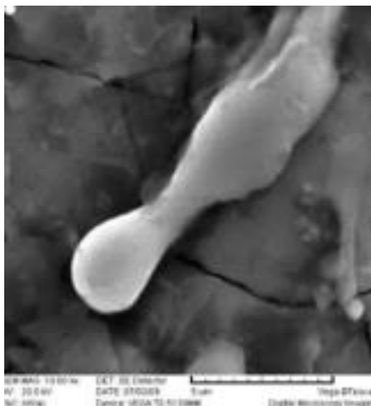
Slika 2.7. SEM snimak bliže periferije ozračene oblasti legure Ti-6Al-4V nakon delovanja 10 impulsa nanosekundnog XeCl lasera [37].
