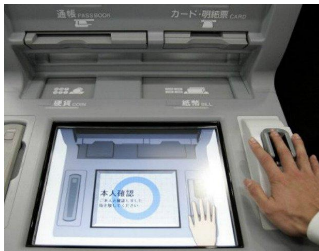
Слика 7. Банкомат са биометријским читавањем (Извор: https://www.muskiportal.com/ , 2012.)
