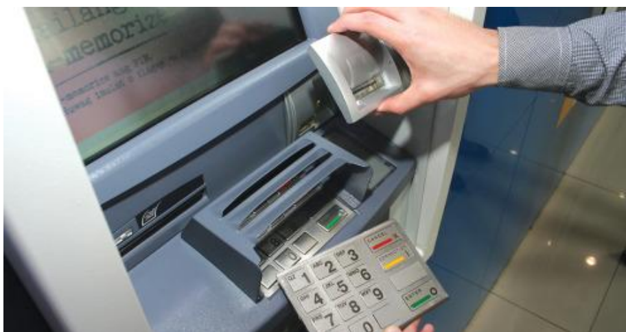
Слика 10. Скимер (Извор: http://www.cwbchicago.com , 2018.)
