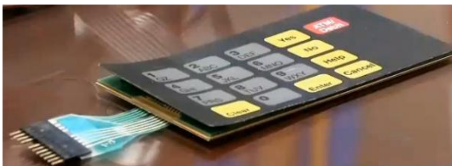
Слика 11. Скимер PIN-а картице за плаћање горива (Извор: https://krebsonsecurity.com/tag/gas-pump-skimmers/ , 2018.)
