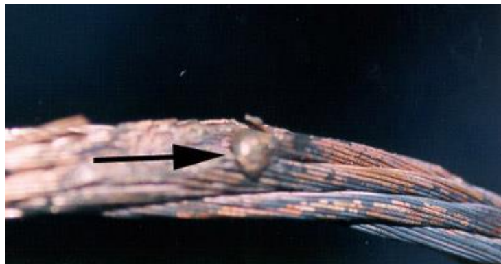
Слика 5. Последице кратког споја преко електричног лука код кога је дошло до појаве истопљених капљица метала
