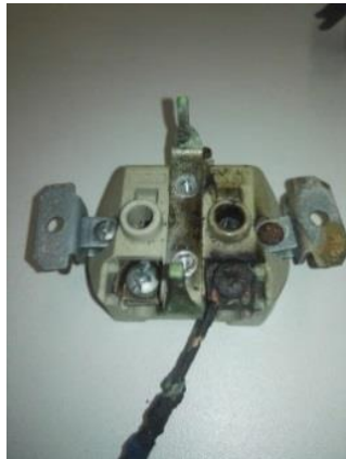
Слика 12. Термички оштећена PVC изолација на прикључку шуко-утичнице (максимална температура на месту контакта износила је преко 700 °C)
