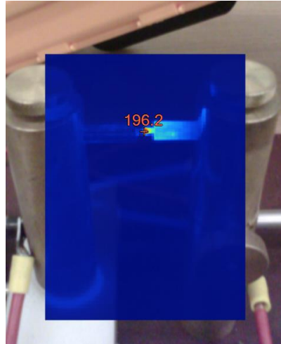
Слика 35. Пример термовизијске слике „вреле“ тачке за комбинацију електрода бакар–нерђајући челик
