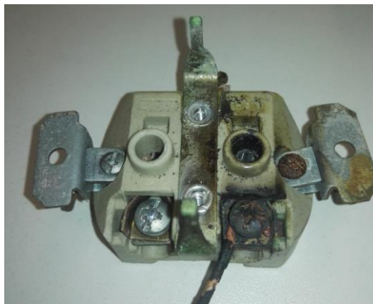
Слика 48. Оксидни слој формиран на десном, завртњем изведеном прикључку, током извршеног експеримента на утичници
