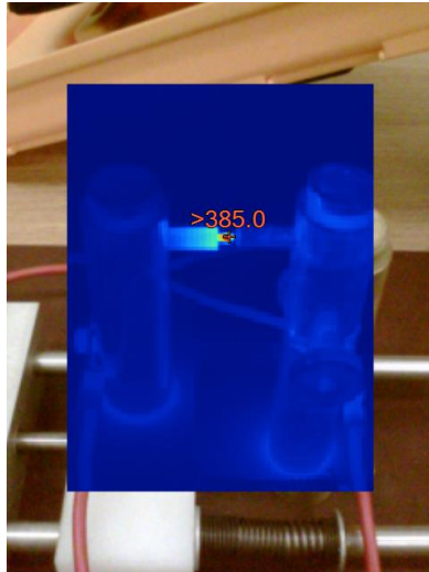
Слика 33. Пример термовизијске слике „вреле“ тачке за комбинацију електрода бакар–месинг
