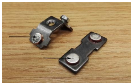
Слика 41. Делови главног прекидача са смањеном површином преклапања бакарних плочица
