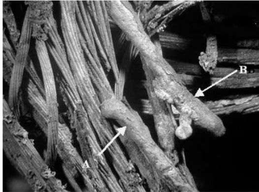
Слика 7. Последице земљоспоја којим је проузрокован велики пожар у једном пословном објекту [18]
