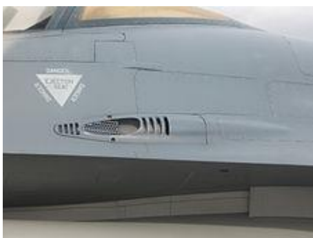
Слика 9- Излаз из топа M61A1 / Преузето са: https://sr.wikipedia.org/sr-ec/F-16
