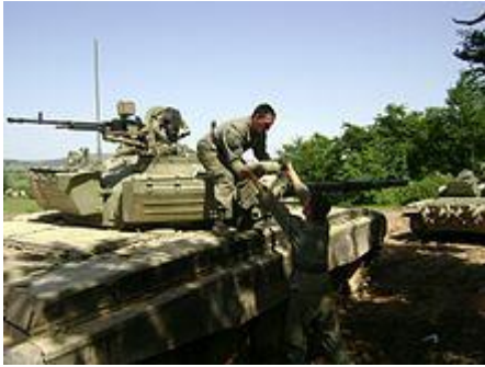
Слика 2.-Утовар муниције. На куполи је смештен противавионски митраљез М87 кал. 12.7mm.
