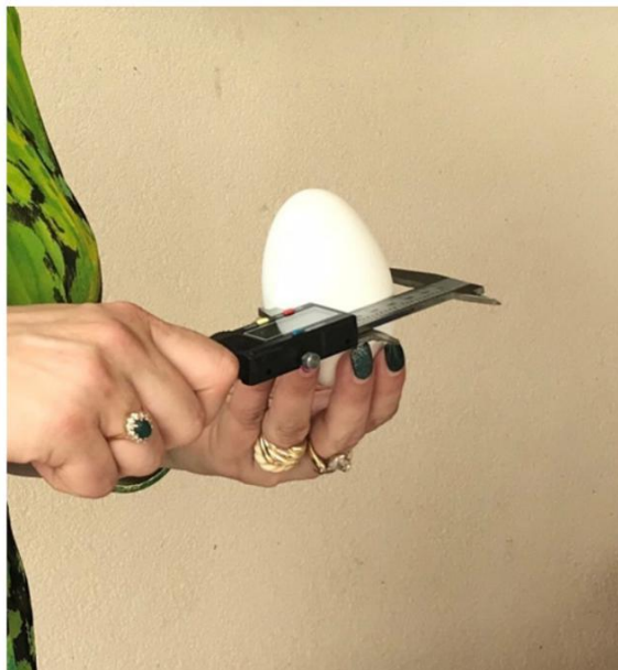
Slika 6. – Individualno merenje širine jajeta pre ulaganja u inkubator (Izvor: Foto – Milojević M.)
