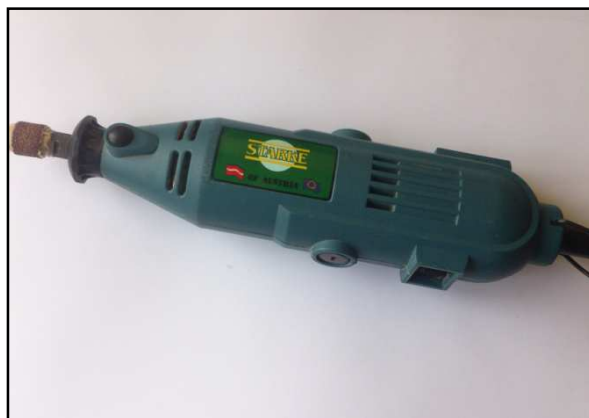
Слика број 9. Хоблерица MINI – BOHRMACHINE, MT – 130
