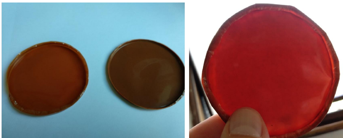
Slika 4.24 – Membrane EC- BaFe 12 O 19
