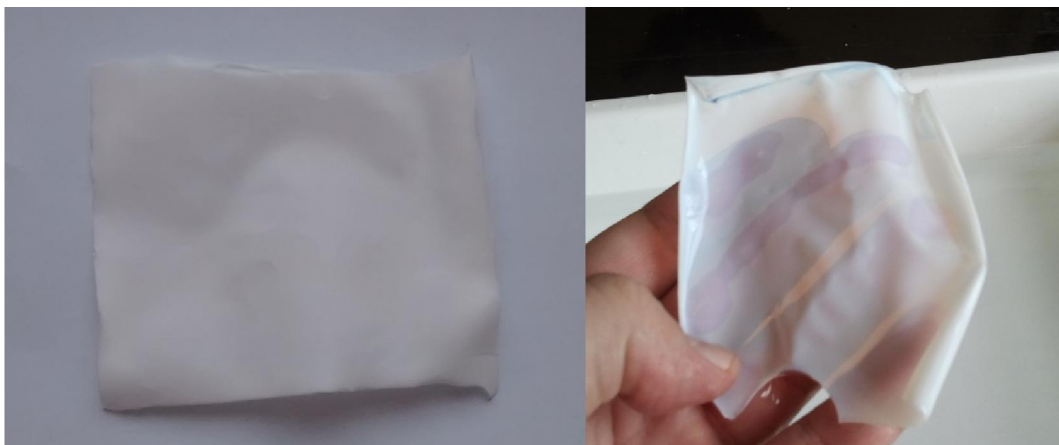
Slika 4.1 – Membrana na bazi hidrogela u suvom (levo) i vlažnom (desno) stanju
