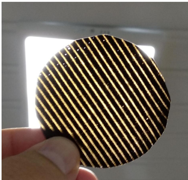
Slika 4.37 – Membrana EC-SrFe 12 O 19
