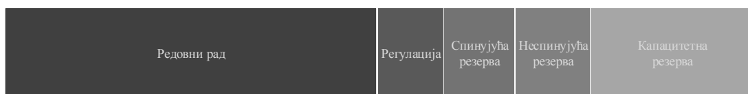
Слика 20. Структура капацитета једног генератора
