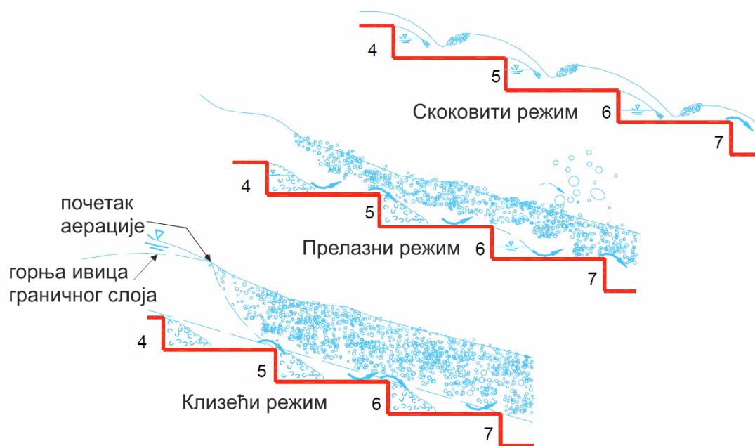
Слика. 2.1: Режимы струјања у степенастом брзотоку. Преузето из González (2005).
